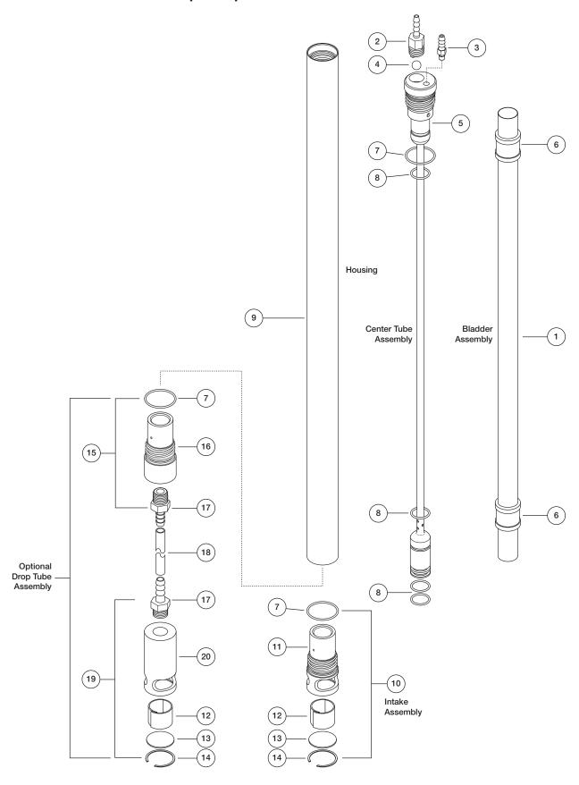
**MODEL .675 PORTABLE BLADDER PUMP CE - 81150117**
